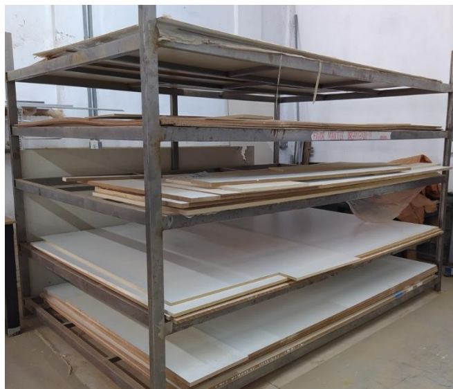
Figura 2 - Estrutura de ferro organizadora de chapas de MDF
