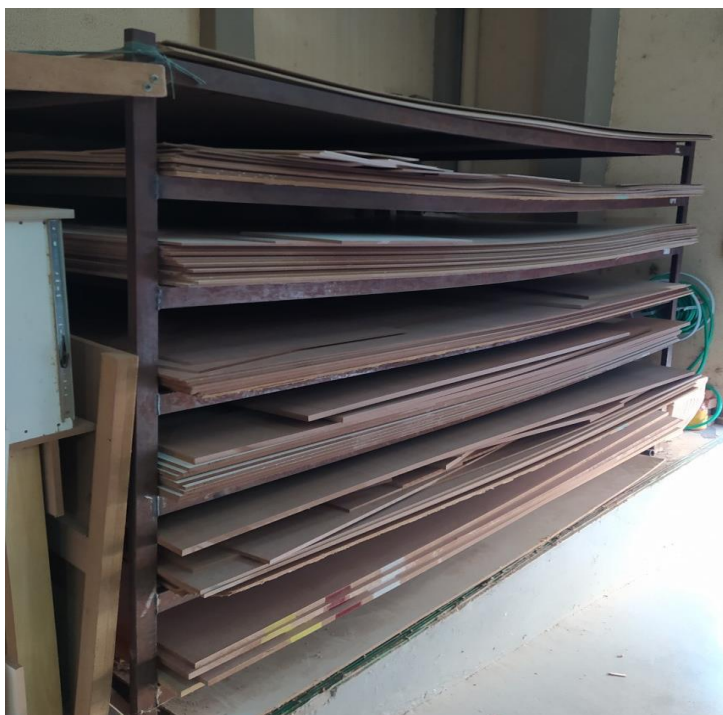
Figura 4- Estrutura de ferro organizadora de chapas de MDF
